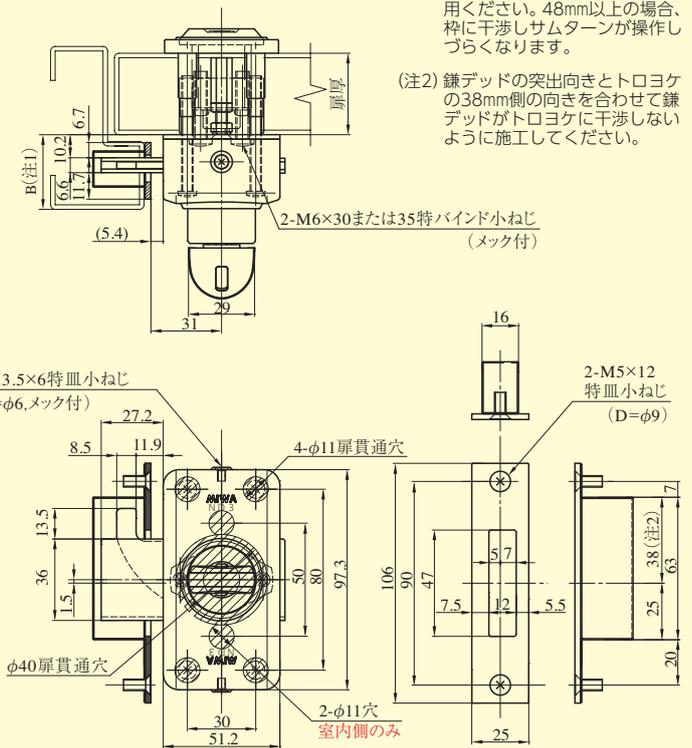
(注1) B寸法が48mm以下の枠にご使用ください。48mm以上の場合、枠に干渉しサムターンが操作しづらくなります。
